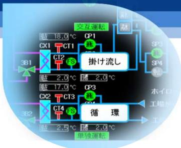
掛け流し冷水、循環冷却水(真空冷却機、ジャケット釜等対応可)同時取出し可能
