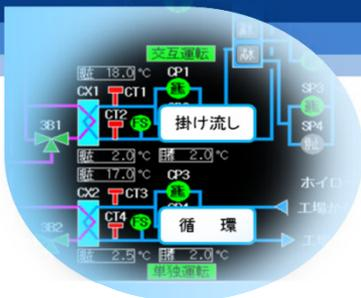
掛流し冷水、循環冷却水(真空冷却機、ジャケット釜等対応可)同時取出し可能
